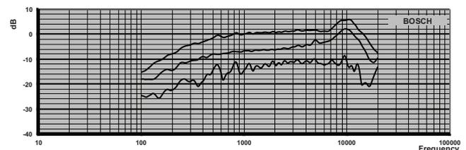
Réponse en fréquence (angle d'ouverture : 0, 90 et 180 degrés)
