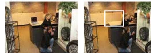
**Sabotage** : Quand le champ de vision d'une caméra est changé (caméra déplacée ou recouverte) celle-ci lance automatiquement une alarme.
