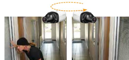
**Ligne virtuelle** : Deux modes possibles pour la fonction ligne virtuelle. Le mode Zone définit une zone virtuelle, le mode Ligne définit une ligne directionnelle, et une alarme est lancée dans le cas d'une intrusion dans la zone ou du franchissement de la ligne.
